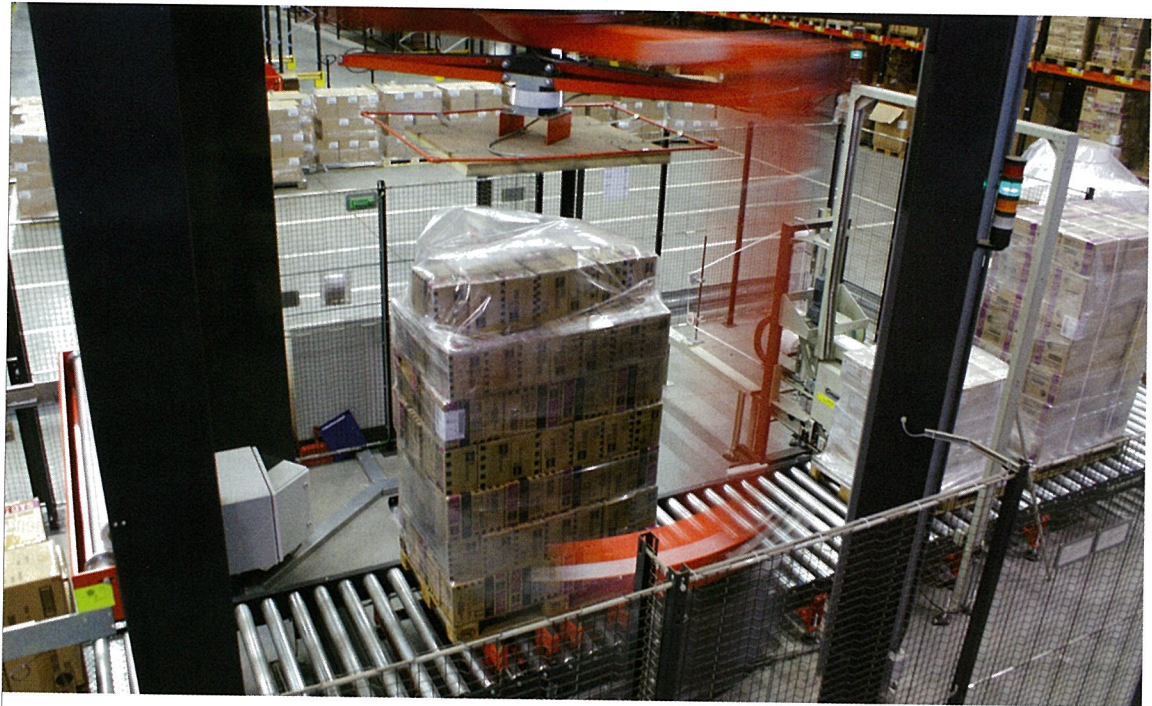
De gepalleteerde lading wordt in een gestage stroom en in hoog tempo gewikkeld
